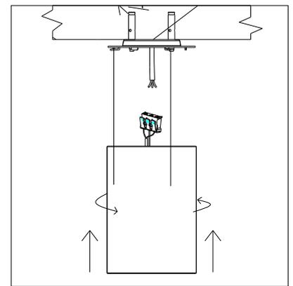
3. Legen Sie den Treiber in das Gehäuse hinein. Verbinden Sie die Zuleitung mit dem Treiber. Montieren Sie das Gehäuse auf dem Befestigungsring und rasten es ein.
