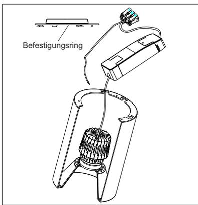
1. Entfernen Sie den vorderen Ring von der Leuchte. Schrauben Sie die Leuchte in das Metallgehäuse ein. Verbinden Sie die Leuchte mit dem Treiber.
