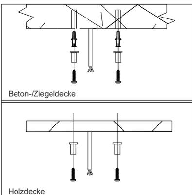
1. Montieren Sie das Seilabhängeset mit entsprechenden Schrauben an die Decke.
