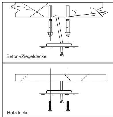
2. Montieren Sie den Befestigungsring mit entsprechenden Schrauben an die Decke. Führen Sie die Zuleitung durch den Befestigungsring.
