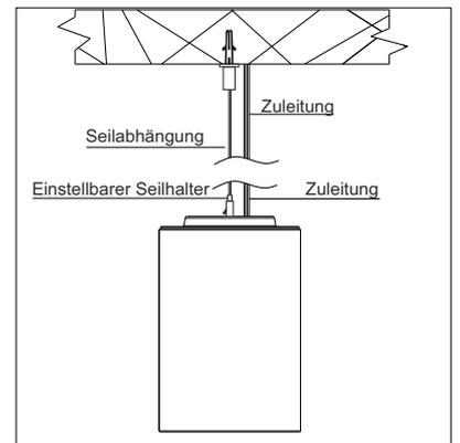
3. Verbinden Sie die Zuleitung mit dem Treiber. Positionieren Sie die Leuchte auf gewünschter Höhe und kürzen das Seil entsprechend.
